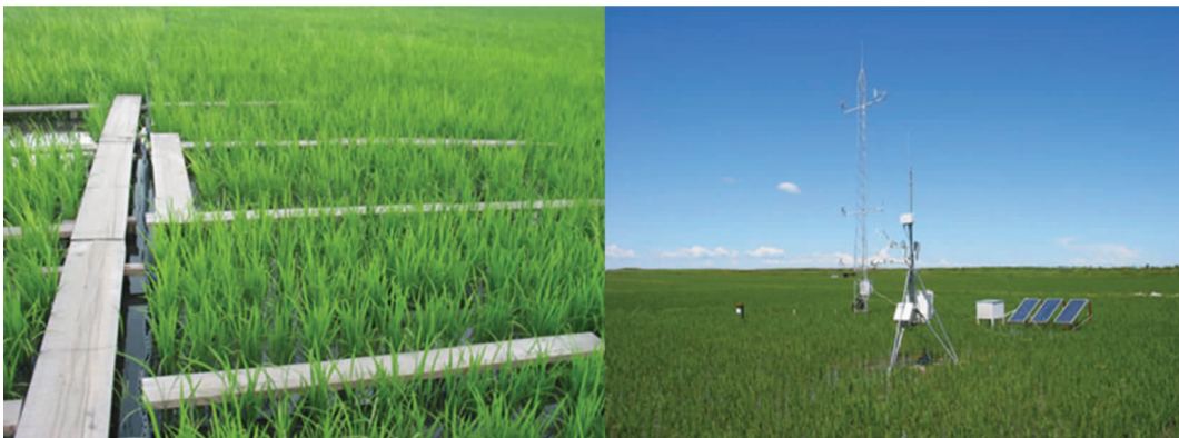
图 25 中国科学院三江站水田辅助观测场和涡度相关观测系统 图片来源：中国科学院三江平原沼泽湿地生态试验站。
