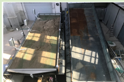
坡面径流侵蚀槽
